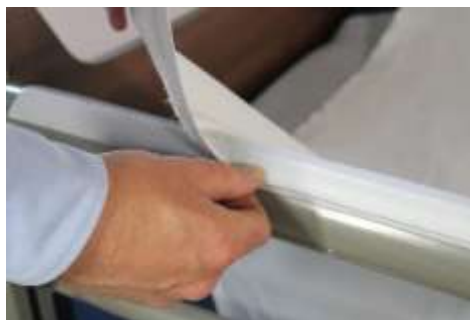
Fig. 5.11.2.1 – Vastmaken van het wentellaken aan de motorrol
